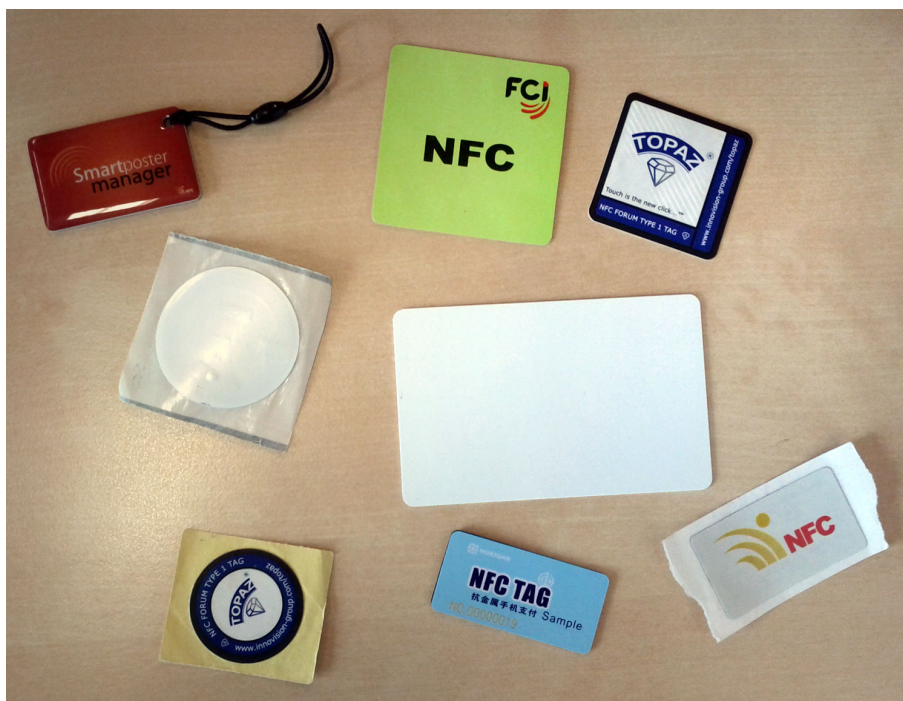
Slika 2.2: NFC značke najdemo v vseh možnih oblikah. Na sliki so primeri različnih nalepk, primer kartice in primer obeska.
