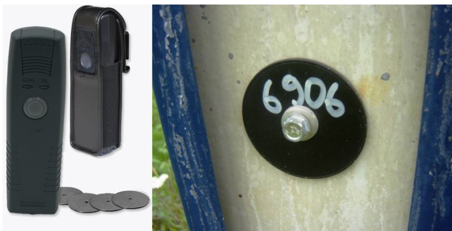
Slika 1.2: Slika prikazuje RF ID čitalec in značko, ki ju uporabljajo pri podjetju eurolakat za označevanje plakatnih mest.
