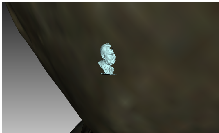
Slika 7.5: Primerjava velikosti rezultata, pridobljenega z metodo fotogrametrije (svetlomoder model), in rezultata merilnika Artec MHT (rjav model).
