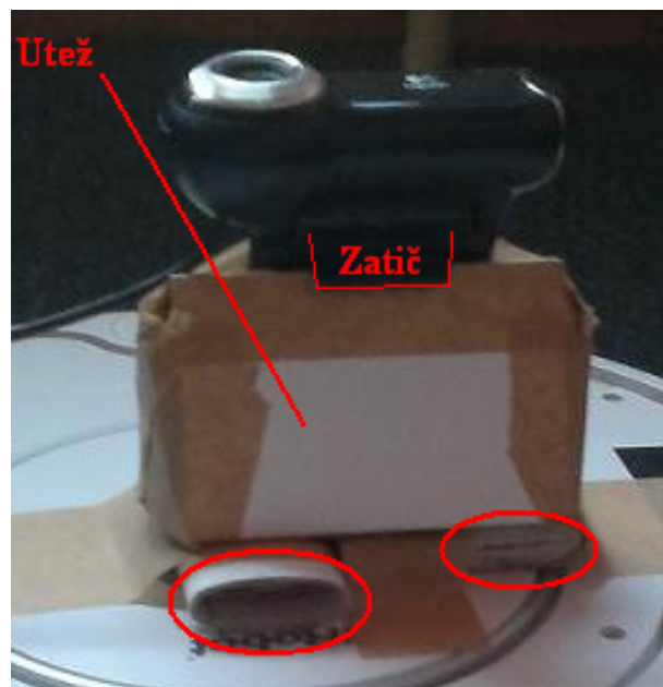
Slika 2.13: Preprečitev rotacije po osi Nagib, tako da smo podložili iz obeh strani.
