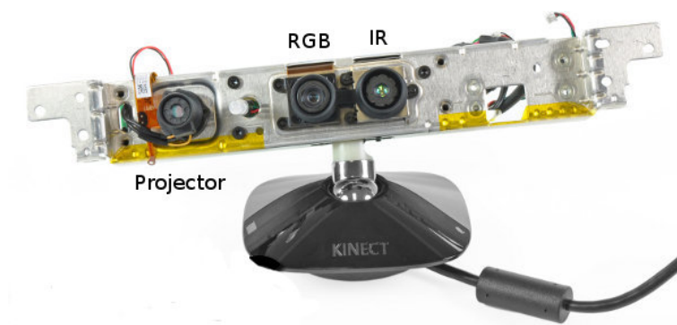
Slika 2.2: Kinect brez plastičnega ohišja.
