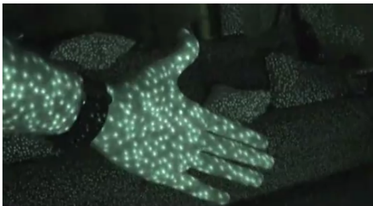
Slika 2.3: Pike infrardeče svetlobe, razporejene po prostoru.
