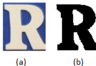
Slika 5.7: Primer binariziranega znaka z Otsu upragovanjem.
