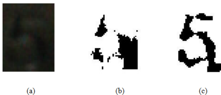
Slika 5.5: Primer binariziranega znaka, z uporabo predprocesiranja in brez. (a) Originalna slika, (b) binarizirana slika s FCM brez predprocesiranja, (c) binarizirana slika s FCM in predprocesiranjem.
