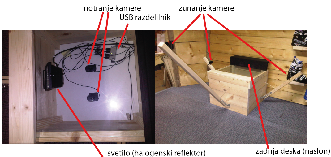
Slika 2.3: Notranji in zunanji izgled merilnega sistema.
