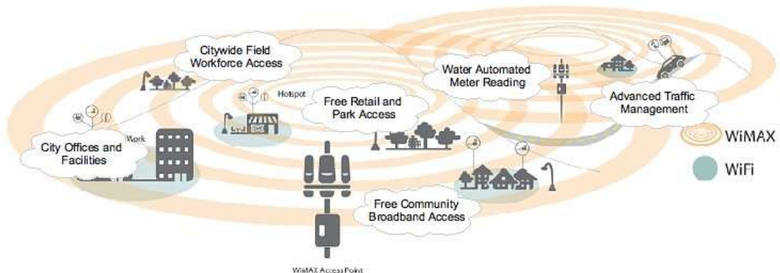
Slika 4: Primer javno dostopnega brezžičnega omrežja v Houstonu (ZDA), podprtega s tehnologijo WiMAX in z območji, pokritimi z Wi-Fi signalom [12]
