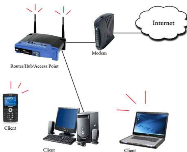
Slika 2: Shema brezžičnega lokalnega omrežja [8]
