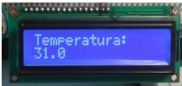
Slika 4.4: Znakovni zaslon LCD 16x2.
