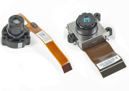
Slika 2: Infrardeči projektor in senzor.
