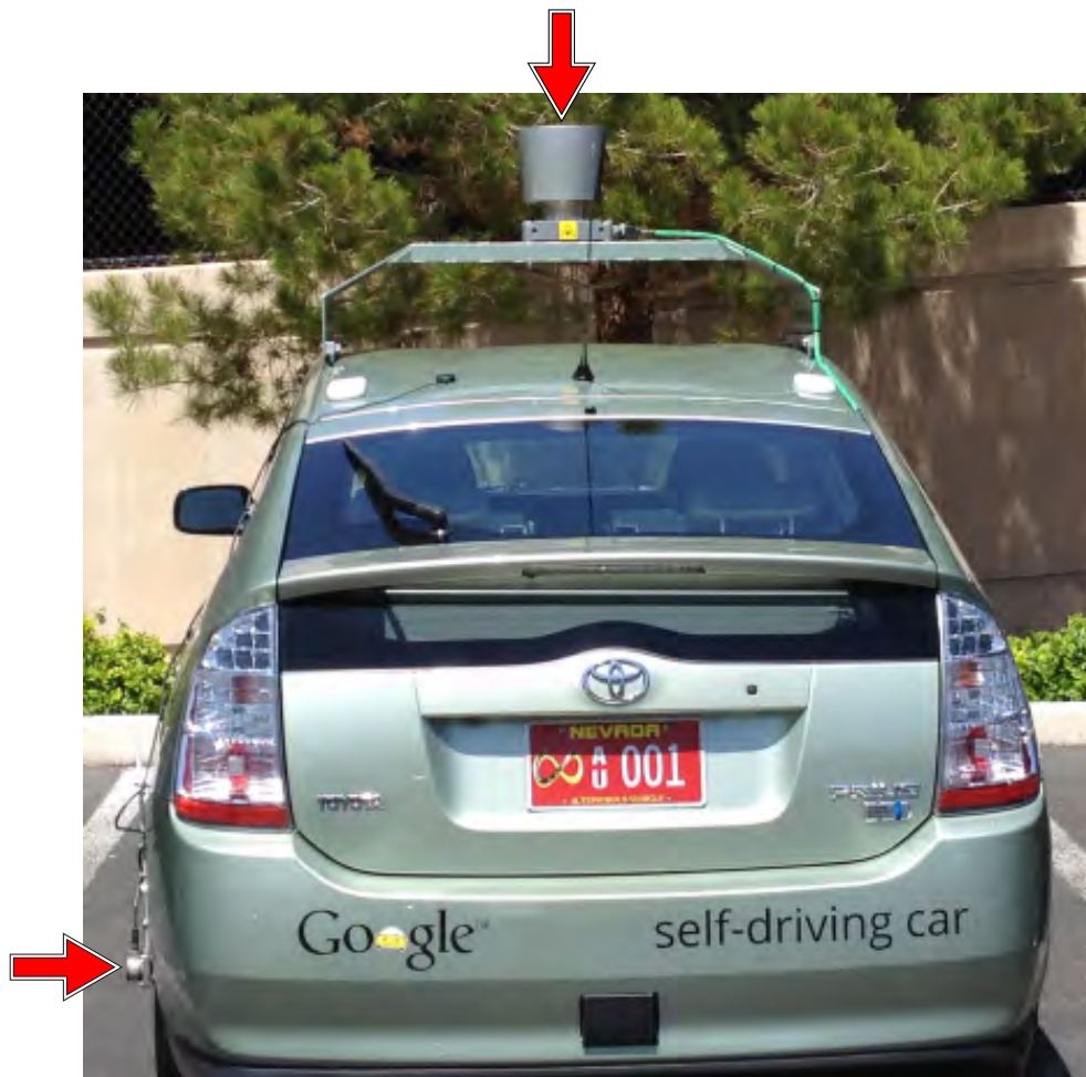
Slika 2.1: Prvi registrirani avtomobil brez voznika. S puščicama sta označena senzor LIDAR (angl. Light Detection And Ranging ) na strehi in položajni senzor na levem zadnjem kolesu.
