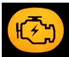
Slika 18: Tipičen izgled kontrolne lučke za zaznane težave na motorju vozila.
