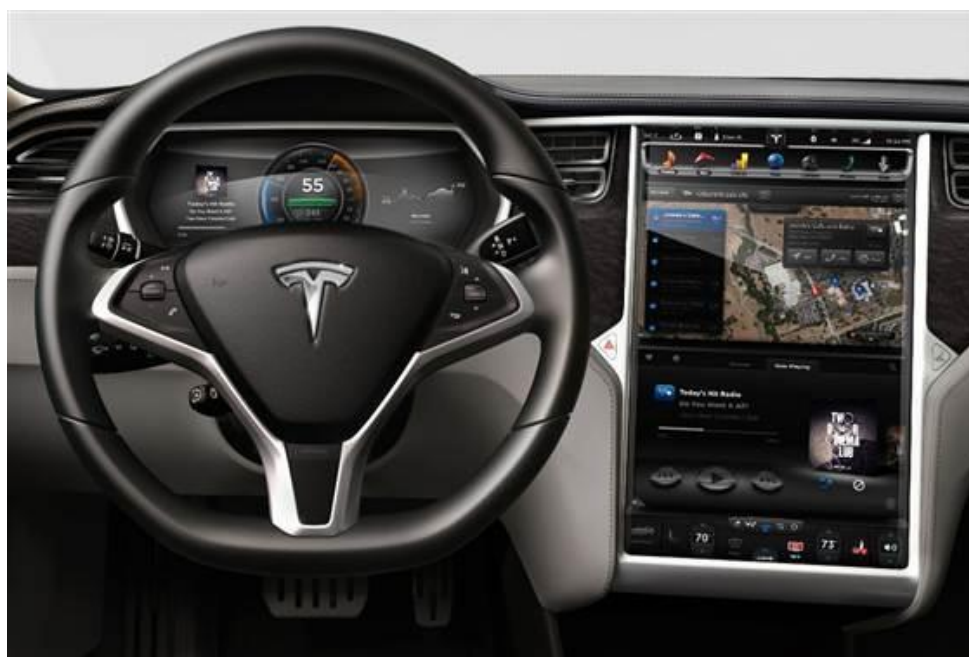
Slika 28: LCD zaslon, občutljiv na dotik kot nadomestilo sredinske konzole.
