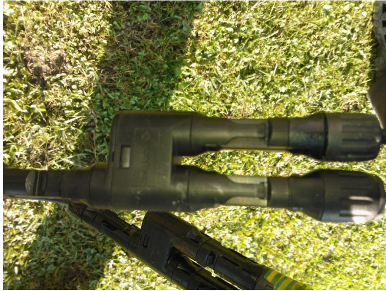
Slika 2.26 Y člen za vzporedno vezavo sončnih modulov
