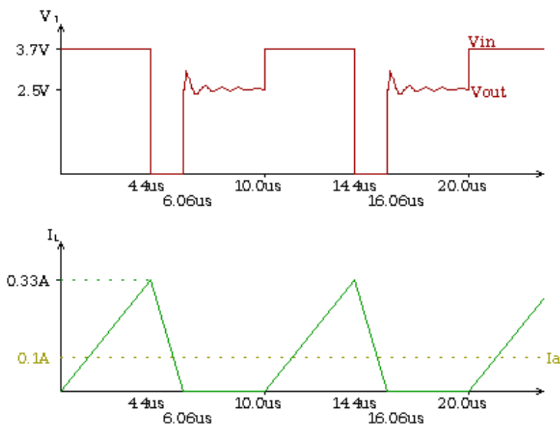
Slika 9: Potek napetosti in toka pri zelo majhnem bremenu
