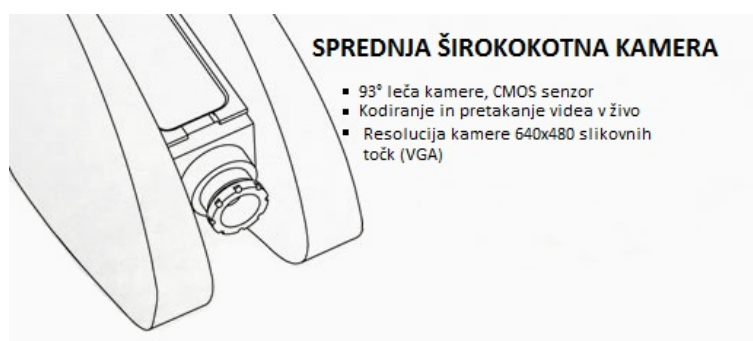
Slika 2.2: Opis osnovne zgradbe in elektronskih komponent. Slika povzeta po [5].
