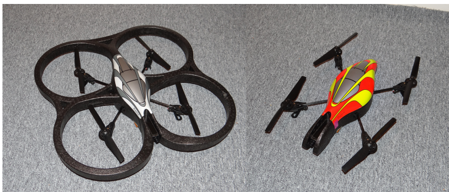
Slika 2.1: Kvadrokoopter s pokrovom z zaščito (levo) in s pokrovom brez zaščite (desno).
