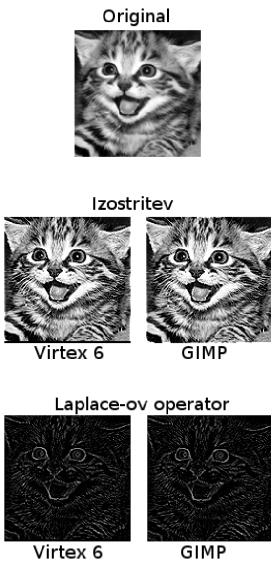
Slika 5.7: Primerjava rezultatov, ki jih dobimo z uporabo konvolucijske matrike v GIMP-u in na naši implementaciji na platformi Xilinx Virtex-6.
