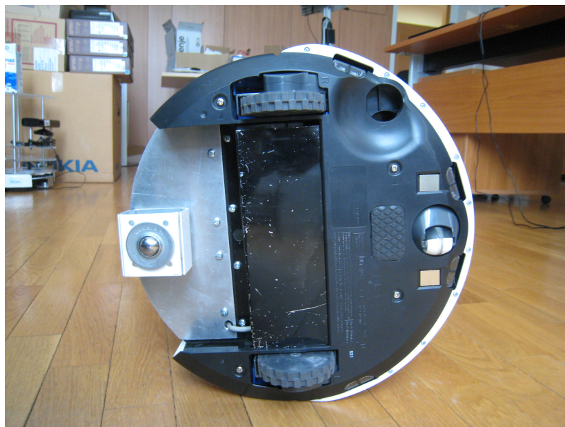
Slika 3.3: Prikaz spodnjega dela predelane Roombe 530, ki smo jo uporabljali v našem sistemu.
