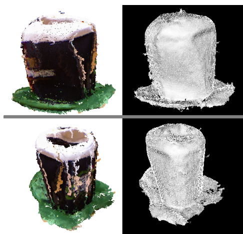
Slika 5.18: Model klobuka v obliki barvnega oblaka točk in poligonske mreže prikazan iz dveh zornih kotov.
