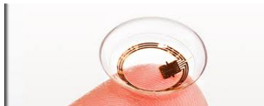
Slika 2.2: Leča z v vgrajeno tuljavo, za merjenje spremembe magnetnega polja.
