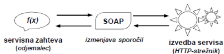
Slika 2.5: Osnovni elementi arhitekture oddaljenih klicev XML-RPC
