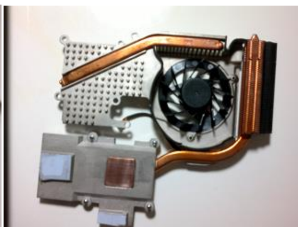
Slika 20: sestavljen in očiščen hladilni sistem
