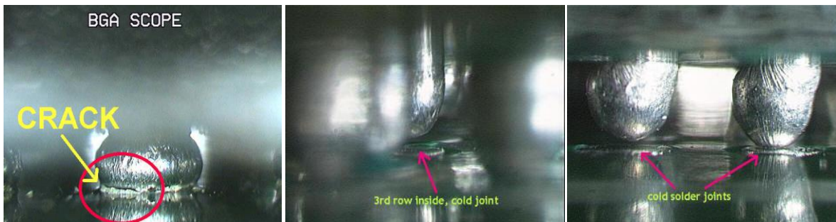
Slika 24 : mikroskopski prikaz slabih spojev
