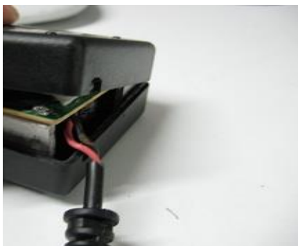
Slika 50: poškodovana žica napajalnika
