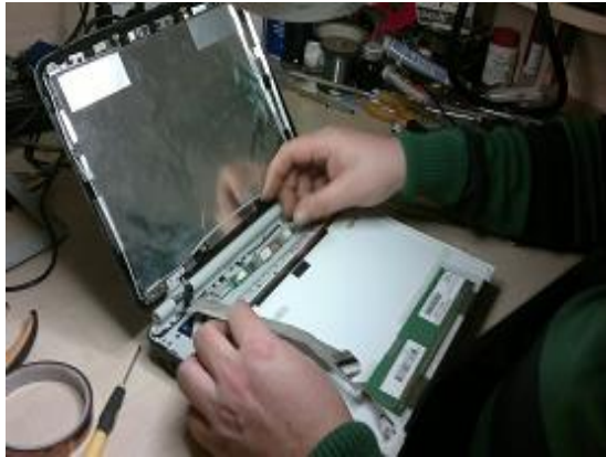
Slika 64: odstranjevanje ploščatega kabla
