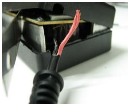
Slika 51: odtrgana žica napajalnika
