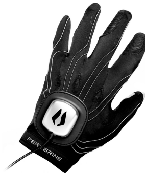
Slika 1.7: Posebna rokavica za 3D interakcijo (vzeto iz [37])
