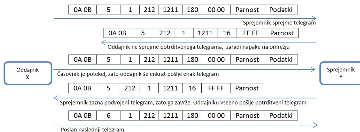
Slika 10: Napaka na omrežju med čakanjem na potrditev.
