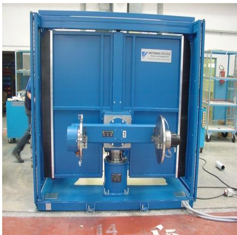
Slika 1: Robotska varilna celica.
