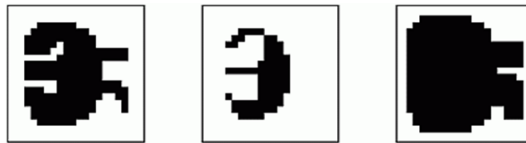
Slika 2.6: Dilatacija in erozija.
