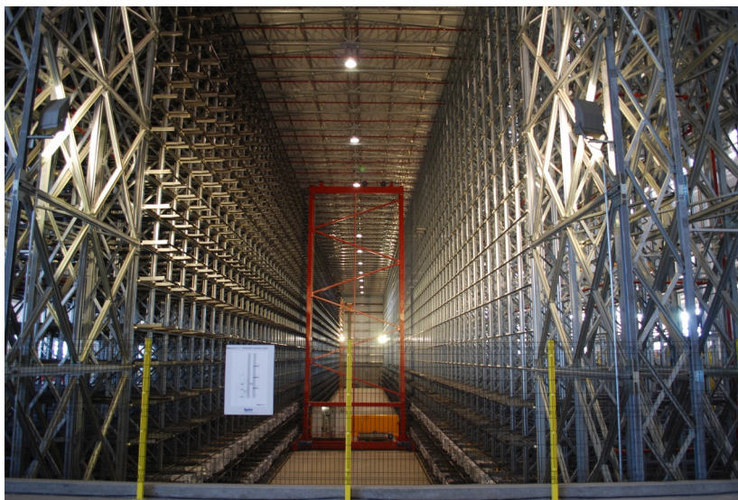
Slika 1.1: Avtomatizirano visokoregalno kasetno skladišče za dolge materiale. Asas, Akyazi - Turčija.
