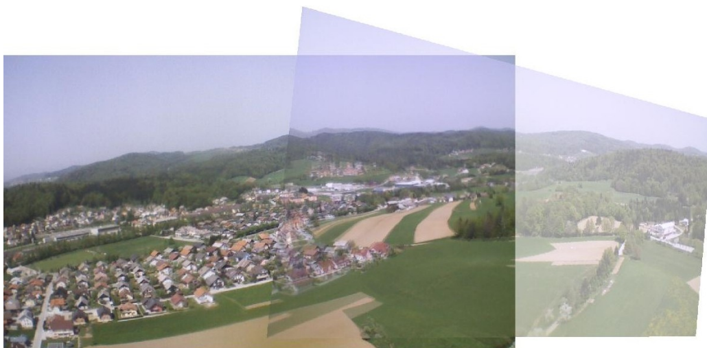
Slika 3.2: Mozaik dveh slik z izrazito radialno distorzijo. Zaradi radialne distorzije ne moremo pravilno združiti slik, kar se opazi pri odstopanjih na gorah in poljih.
