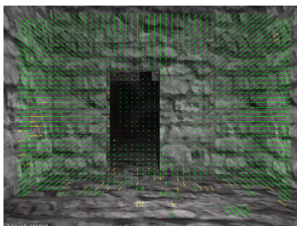
Slika 2.7: Primer gostega optičnega toka. Slika je povzeta po [32].
