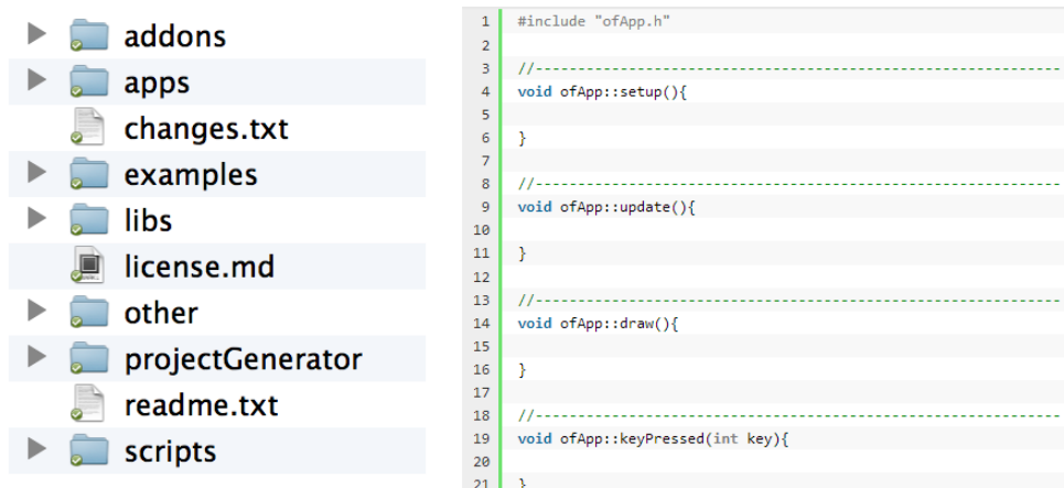
Slika 4.5 Hierarhična urejenost direktorijev (levo) in osnovna arhitektura aplikacije v ogrodju OpenFrameworks (desno) [22].
