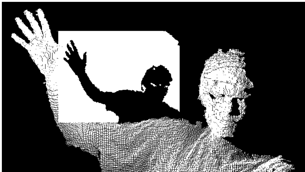
Slika 5.2 Primer celotnega oblaka globinskih točk, ki nam ga posreduje Kinect.
