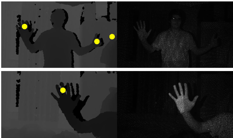
Slika 5.3 Primeri globinskih slik s pravilno (in zgoraj tudi napačno) detekcijo dlani ter pripadajočih IR slik iz infrardeče kamere.
