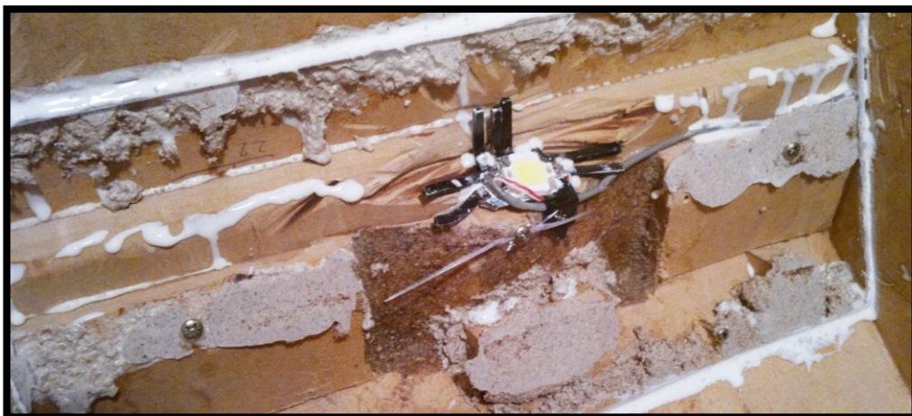
Slika 11: Bliskavica LED, ki je dioda LED z visoko močjo, kar 10W, skrita pod pleksi steklom, ki je zadnja stena zračnika v nizkotonskem zvočniku.
