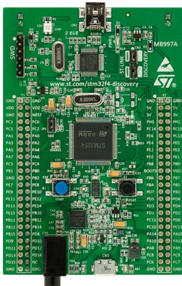
Slika 3: Razvojna ploščica STM32F4-Discovery z mikrokrmlnikom ki ima jedro ARM Cortex M4F [1].
