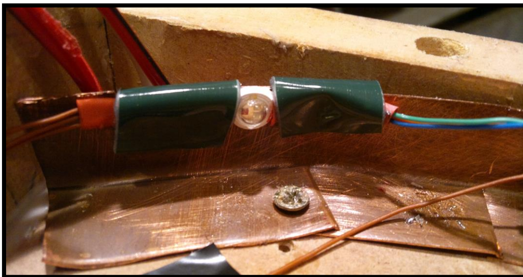
Slika 9: Dioda RGB LED z visoko močjo, nameščena na bakren hladilnik.
