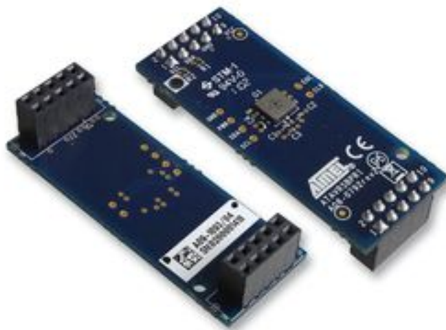
Slika 4.2: Slika senzorja BMP085 na evalvacijski ploščici ATAVRSBPR1[29]
