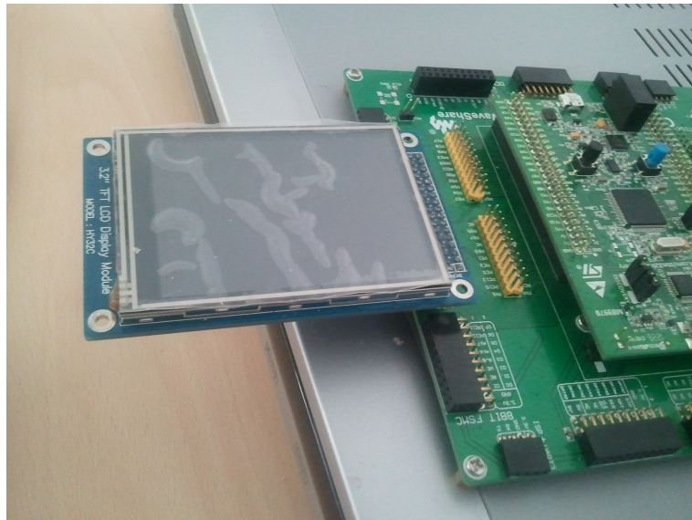
Slika 2.5: LCD zaslon priključen na razvojno ploščo Open407V-D.
