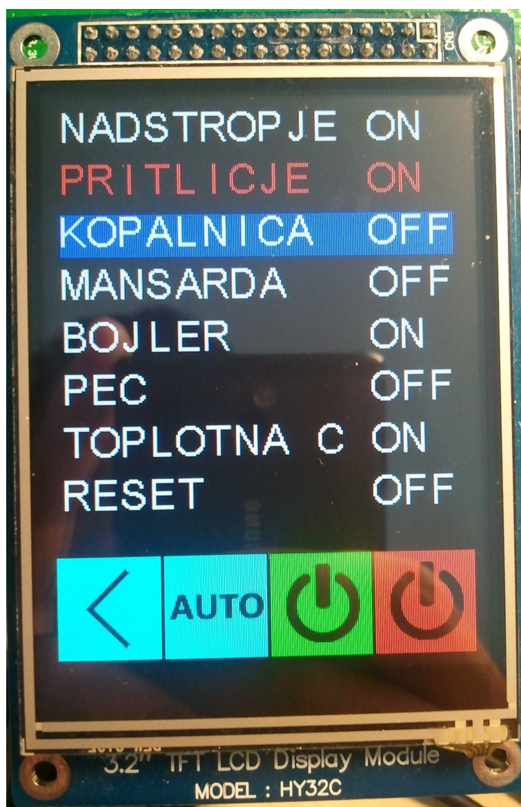
Slika 3.7: Primer zaslona LCD_RELAY ko je rele pritličje ročno vključen, označen je pa rele kopalnica.
