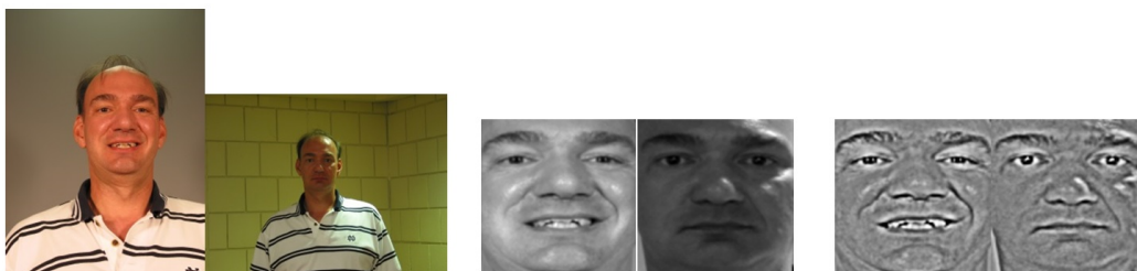
Slika 2.5: Ilustracija učinka normiranja: vhodne slike (levo), po detekciji in geometrijskem normiranju (sredina), po svetlobnem normiranju (desno)
