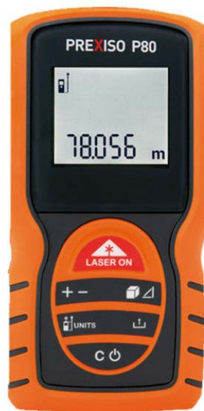
Slika 33: Laserski merilec razdalje Prex ISO P80. [11]
