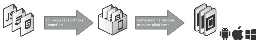
Slika 3.1: Postopek razvoja aplikacije z ogrodjem PhoneGap. Aplikacijo zapakiramo z ogrodjem PhoneGap in jo distribuirati na različne mobilne platforme [12].
