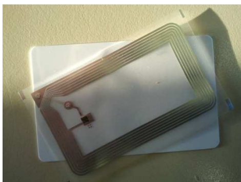
Slika 3: Izgled značke RFID; Antena in čip
