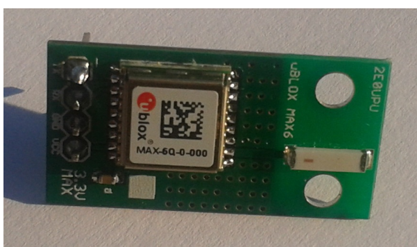
Slika 2.4: Sprejemnik MAX-6, vgrajen na tiskanem vezju, skupaj s sprejemno anteno.
