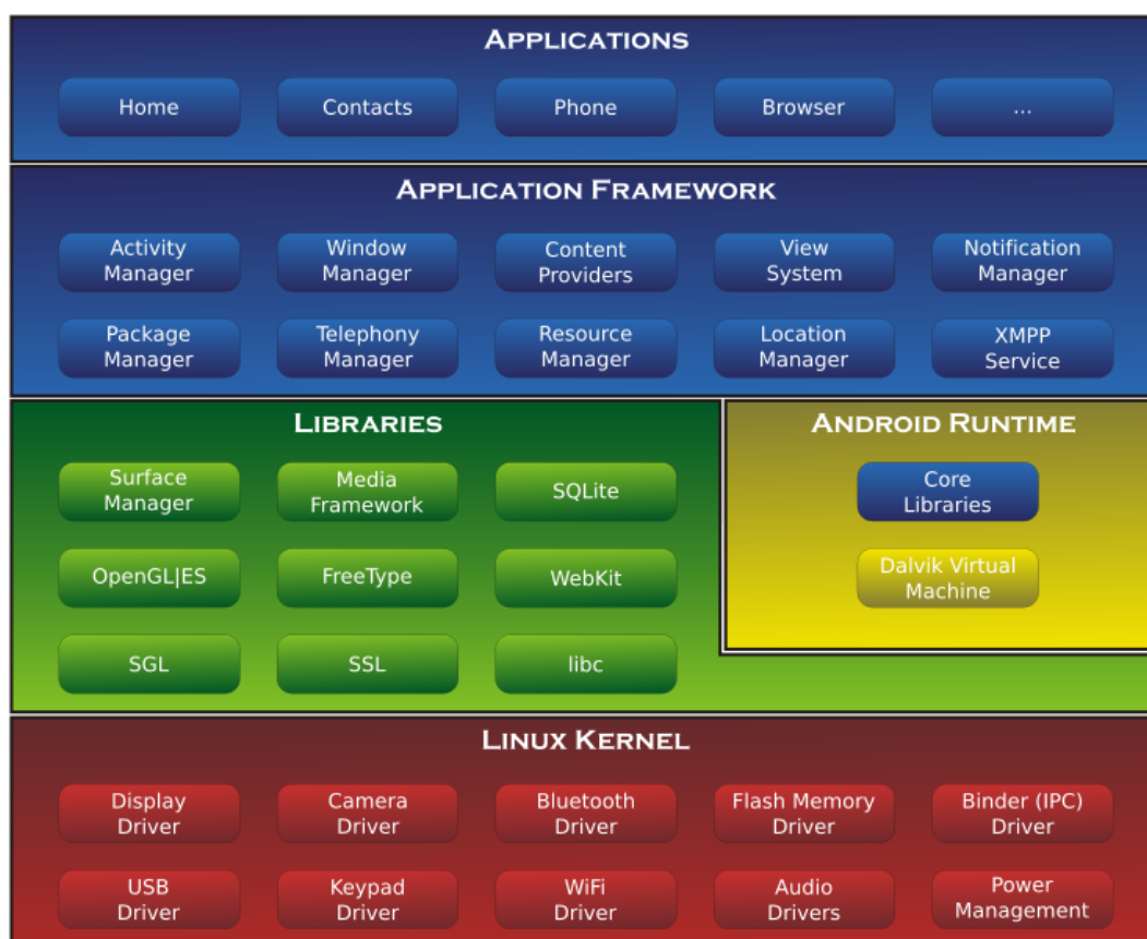
Slika 2.10: Arhitektura operacijskega sistema Android.
