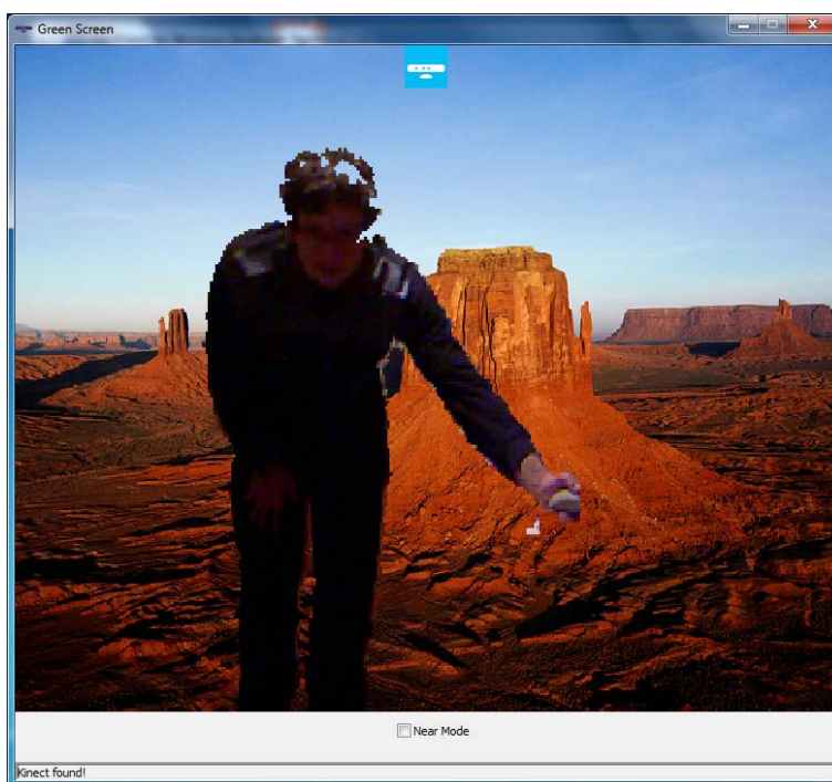
Slika 3.9: Demonstracijski program “Green Screen”, ki uporabi Kinect za postavitev osebe pred navidezno ozadje.
