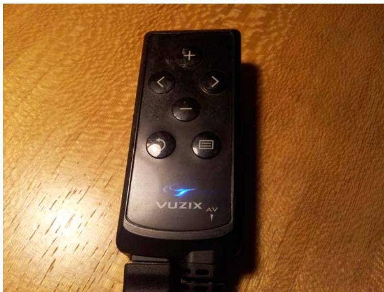
Slika 3.13: Kontrolna ploščica za AR očala – omogoča nastavitve zaslončkov in načina stereoskopskega predvajanja.
