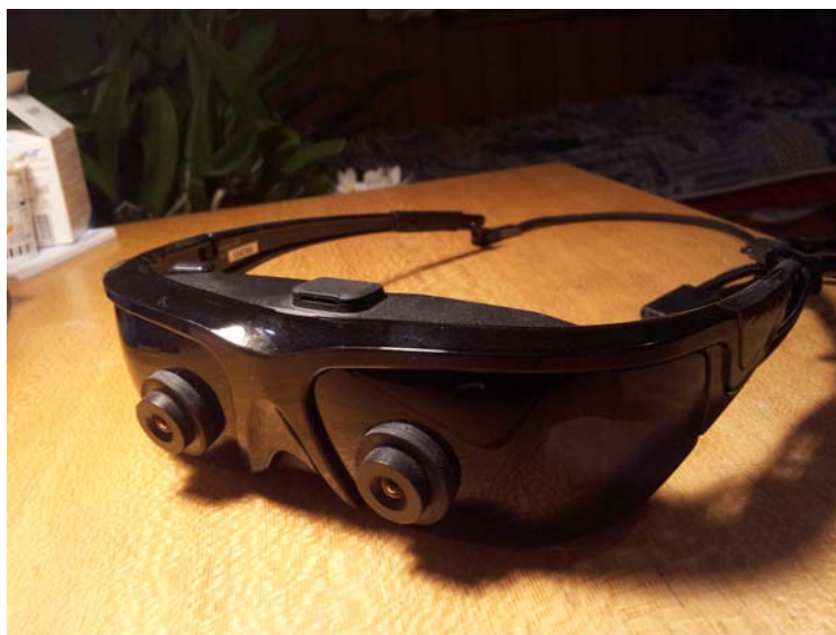
Slika 3.11: Očala za obogateno resničnost Vuzix Wrap 920AR, v ospredju lahko vidimo obe kameri za zajem stereo slike.
