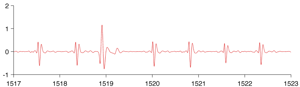
Slika 3.8: Izhod Butterworthovega pasovnoprepustnega filtra y(n) .
