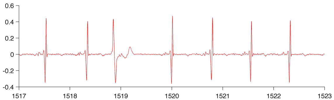
Slika 3.3: Izhod diferenciatorja z(k) .
