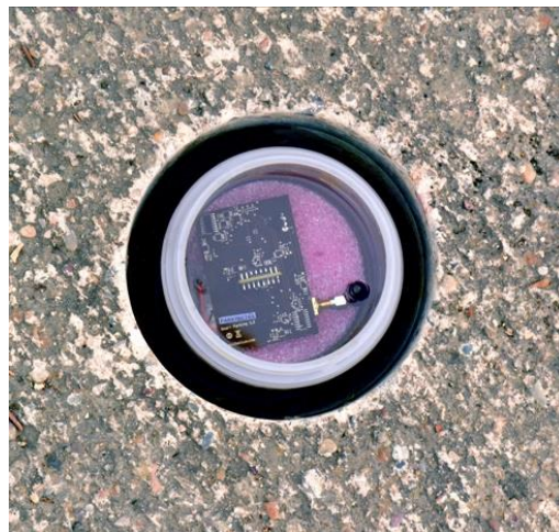
Slika 5: Senzor parkirnega mesta
