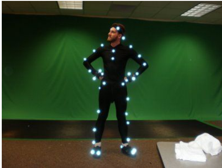
Slika 7.6: Optični sistem za zajemanje gibanja s kamerami in obleko z nameščenimi senzorji 6 .
