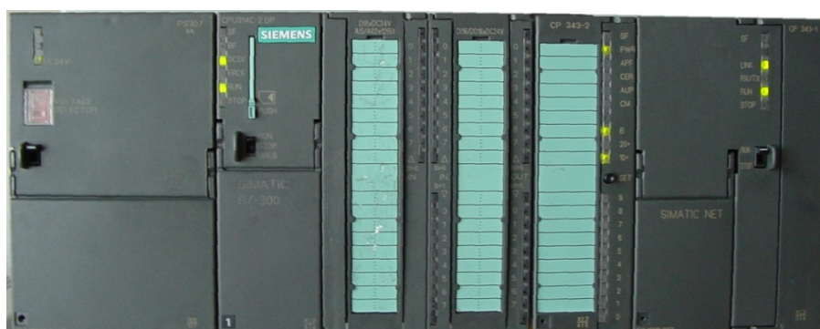
Slika 4.2. Programirljivi logični krmilnik Siemens S7-314C-2DP.
