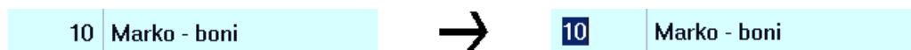
Slika 3.5: Labelo, ki prikazuje vrednost polja, prekrije vpisno polje, ki ne podpira desne poravnave besedila.
