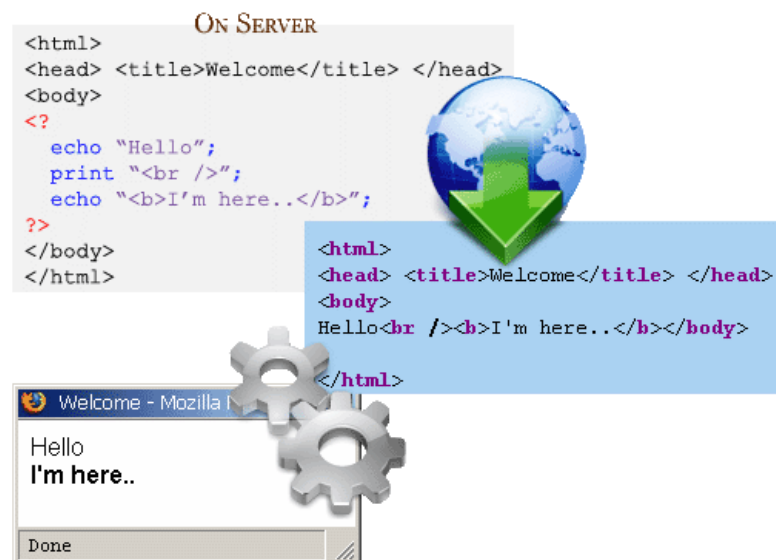
Slika 2: Primer pretvorbe PHP kode v HTML in prikaz v spletnem brskalniku
