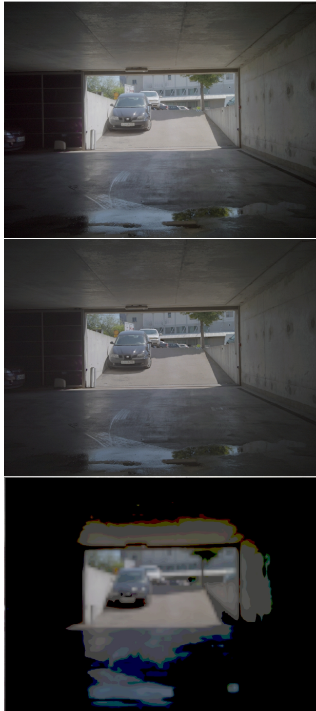
Slika 6.7: Slika pred odstranitvijo odbojev zgoraj, po odstranitvi sredina in slika svetlobnih odbojev spodaj.
