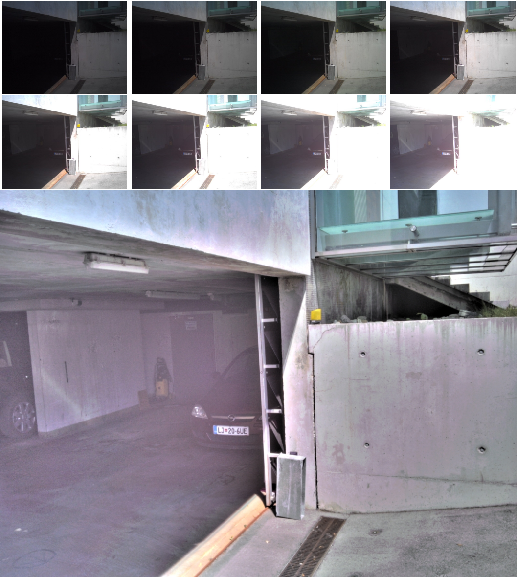
Slika 6.5: Serija 8 NDR-slik zgoraj in VDR-slika spodaj. Razpon časa izpostavitve od 187\mu s do 24000\mu s . Za preslikavo bravnih tonov je uporabljen Fattal algoritem.
