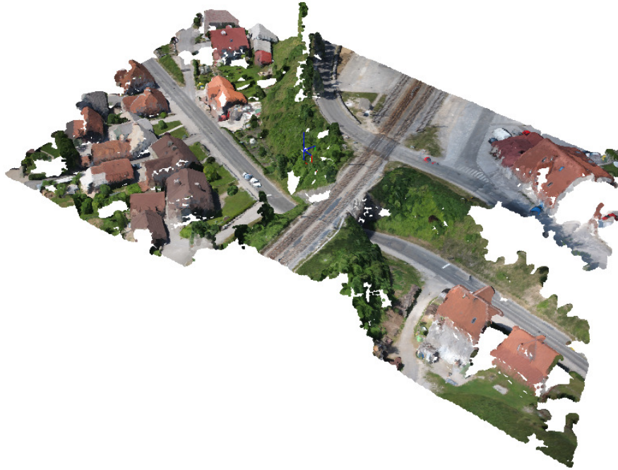
Slika 1.2: Primer oblaka točk zajetega z avtonomnim letalnikom.
