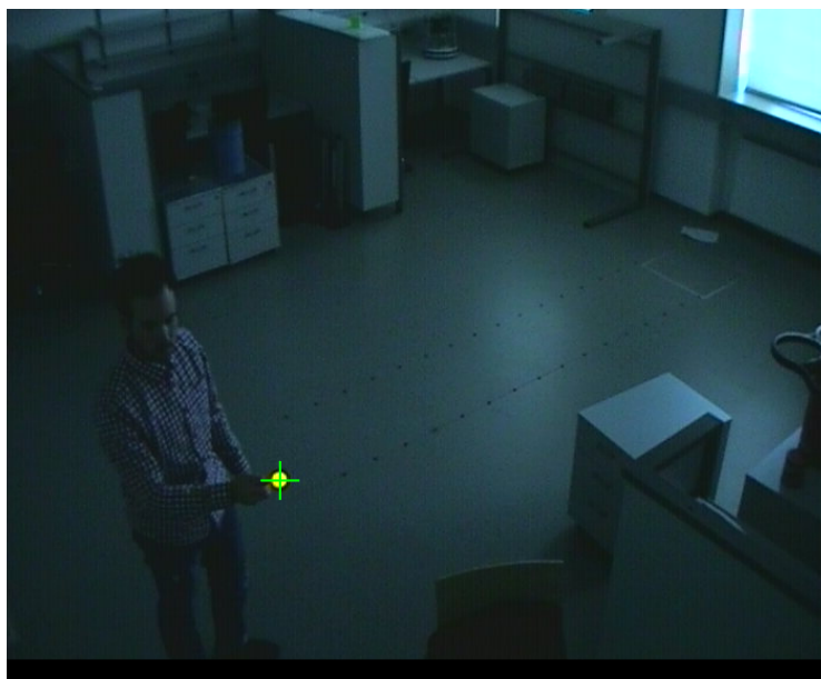
Slika 3.11: Pozicijo označevalnika na sliki (zeleni +) dobimo z masnim središčem segmenta.
