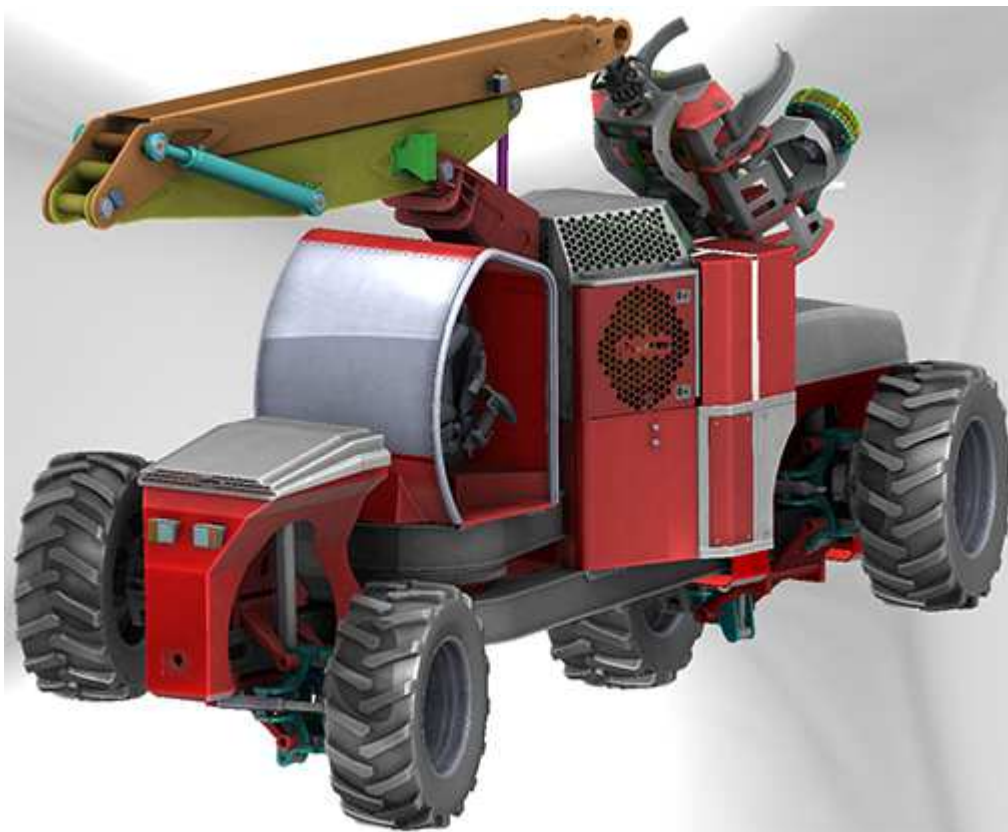
Slika 5.1 Prikazan je 3D model obravnavanega vozila. Lahko opazimo, da je sprednje levo kolo v spodnji skrajni legi, medtem ko je sprednje desno kolo v zgornji skrajni legi. Zadnje levo kolo je prav tako v zgornji skrajni legi, medtem ko je zadnje desno kolo v spodnji skrajni legi. Slika je objavljena z dovoljenjem podjetja Tajfun Planina d.o.o.
