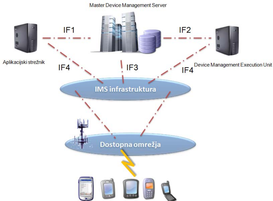
Slika 16: Arhitektura sistema za upravljanje z mobilnimi napravami [37]
