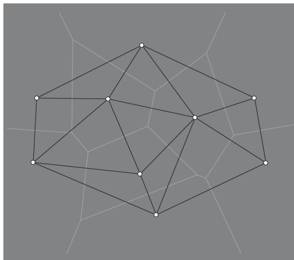
Slika 2.8: Prikazuje s črno Delaunayevo triangulacijo \mathcal{DT}(\mathcal{P}) in s svetlo sivo Voronoijev diagram Vor(\mathcal{P}) .
