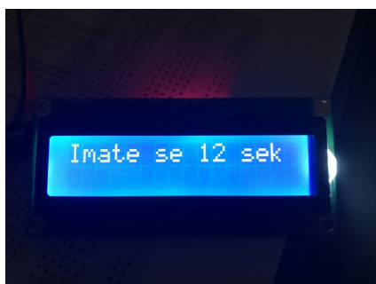
Slika 5.13: Sprožitev odštevalnika časa ob zaznavi nagiba kljuke s senzorjem nagiba SW-520D
